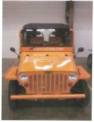
Le Volteis est très simple d'utilisation : une simple prise standard 220volt-16Ah permet une recharge complète de la batterie (plomb au gel) en 6h et 75% en 3h. Il atteint 70 km/h en vitesse de pointe pour une autonomie de 60 km et consomme 8 kw (soit Fr. 1,50); son entretien est réduit au strict minimum (pas de vidange, pas de remplacement de bougie, ni de courroie,...).
